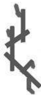
Рисунок 3.1.5 – Схематичное изображение участка проводящего кластера, состоящего из изотропных и анизотропных частиц УНТ
