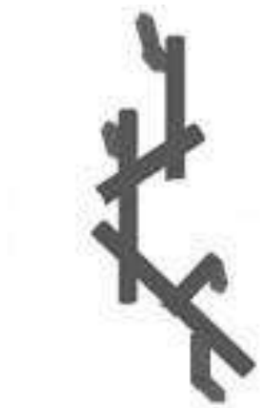
Рисунок 2.2.10 – Идеальный проводящий кластер, сформированный из коротких и длинных частиц УНТ
